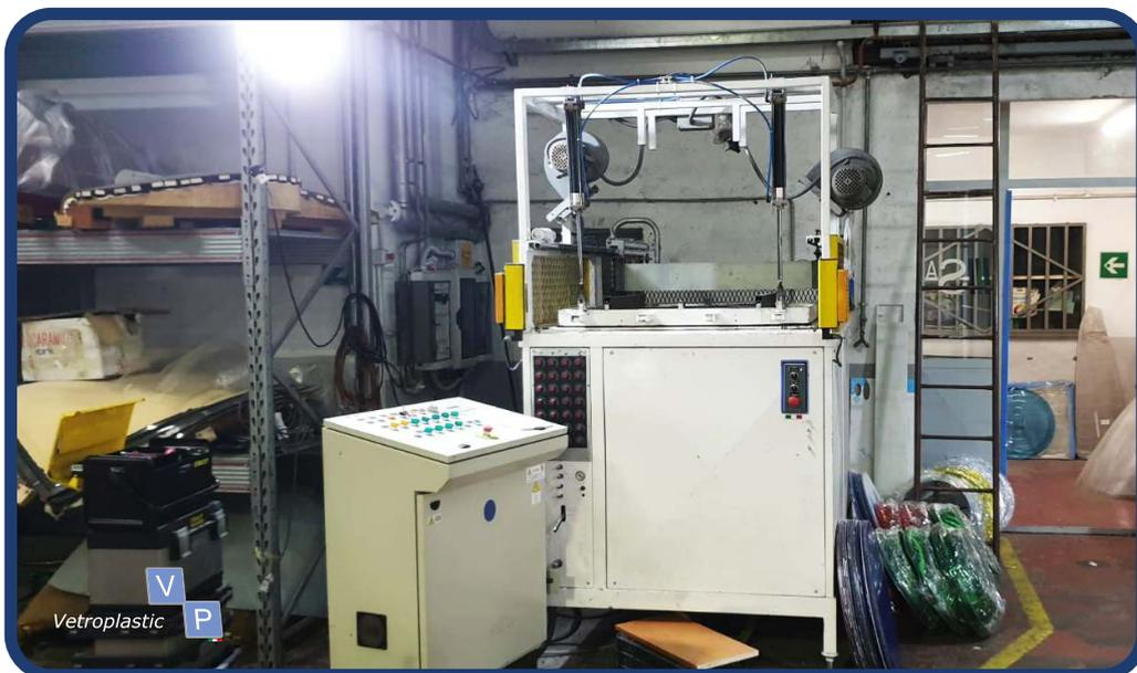
*Termoformatrice automatica per materie plastiche con raffreddamento programmato.*
