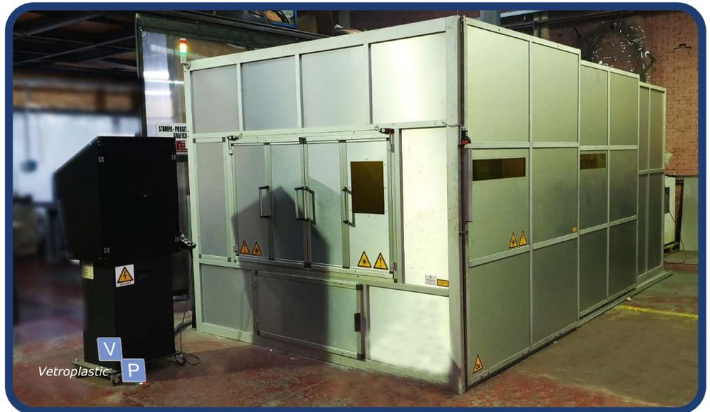
*Laser Fibra taglio metalli per applicazioni aeronautiche con potenza di 1500Watt. Tagli puliti e di alta qualità.*
