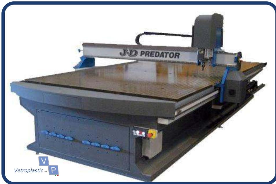
*Il nostro parco macchine vanta numerose attrezzature per rispondere al meglio alle esigenze dei nostri clienti, tra cui un pantografo CNC per plastica, legno e alluminio.*
